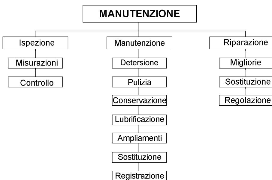
Fig. 5-1: Manutenzione - Definizione secondo DIN 31 051
